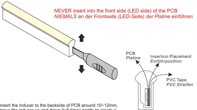
Führen Sie das Einführwerkzeug hinter der Platine ca. 10-12 mm ein. Bewegen Sie das Einführwerkzeug ca. 3-5 Mal vorsichtig auf und ab, damit ein kleiner Hohlraum entsteht.
