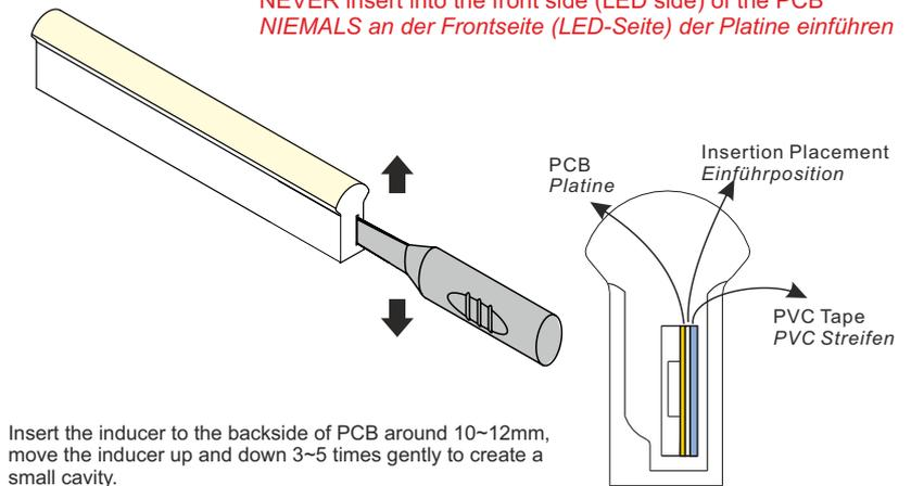
Führen Sie das Einführwerkzeug hinter der Platine ca. 10-12 mm ein. Bewegen Sie das Einführwerkzeug ca. 3-5 Mal vorsichtig auf und ab, damit ein kleiner Hohlraum entsteht.
