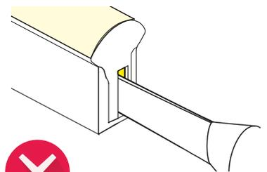
It will damage the tube if insert into front side of PCB / Wenn das Einführwerkzeug auf der Vorderseite der Platine eingeführt wird, zerstört es den Tube.
