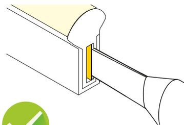
Insert the inducer into the backside of PCB / Führen Sie das Einführwerkzeug auf der Rückseite der Platine ein.
